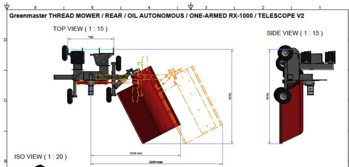
**Greenmaster montato posteriore con alimentazione autonoma dell'olio**
